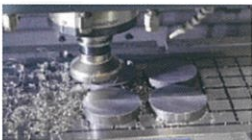
カネテック 小物薄物ワークに最適な 35mm角極小磁極の電磁チャック
